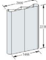
VA 4723 P1 2 Paneles con terminales
